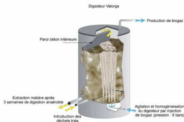
Figura 8 – Modelo esquemático do reator Valorga
