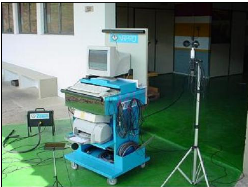
Figura 8 - Equipamentos de inspeção de emissões da Estação Fixa
