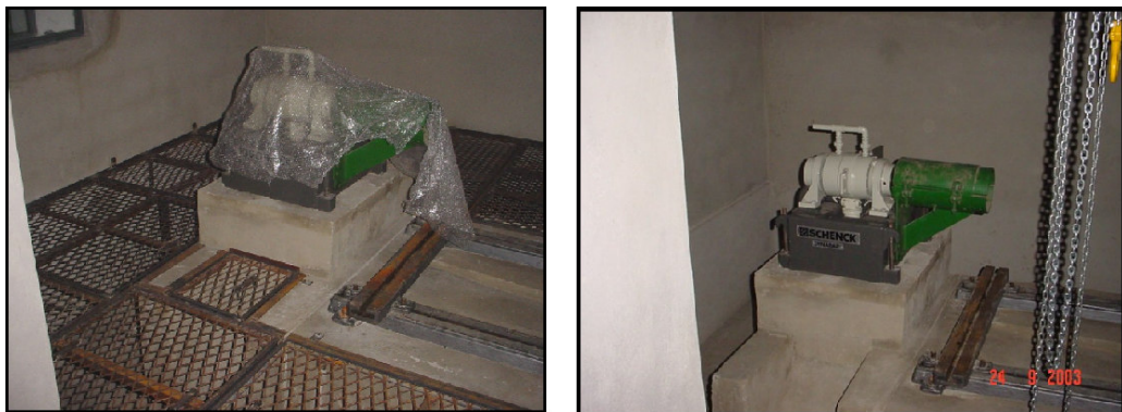
Figura 10 - Fotos do dinamômetro de bancada em fase final de montagem no Laboratório de Motores do Departamento de Engenharia Mecânica da UFMG
