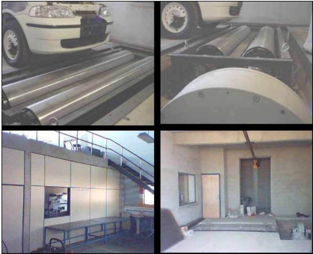
Figura 9 - Fotos do dinamômetro de rolos em fase final de montagem no Laboratório de Motores do Departamento de Engenharia Mecânica da UFMG
