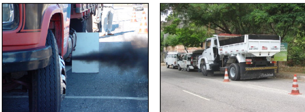
Figura 13 - Inspeção de emissão de opacidade de caminhões a diesel de Belo Horizonte
