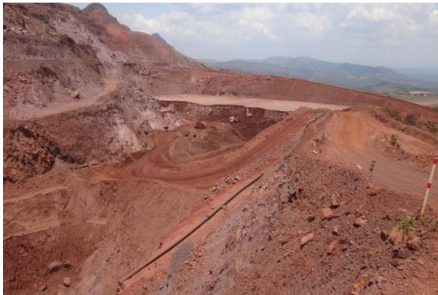
Figura 1 - Enchimento de cava com rejeitos provenientes da planta de concentração.
