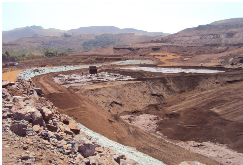
Figura 2 - Disposição do empilhamento drenado de rejeitos.
