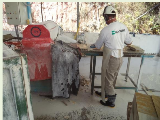
Figura 2 – Serra de disco diamantada, com avanço manual de bancada, utilizada para esquadrejamento das lajotas
