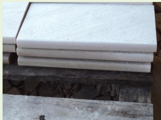
Figura 4 – Acabamento do quartzito, conhecida por “bolear”
