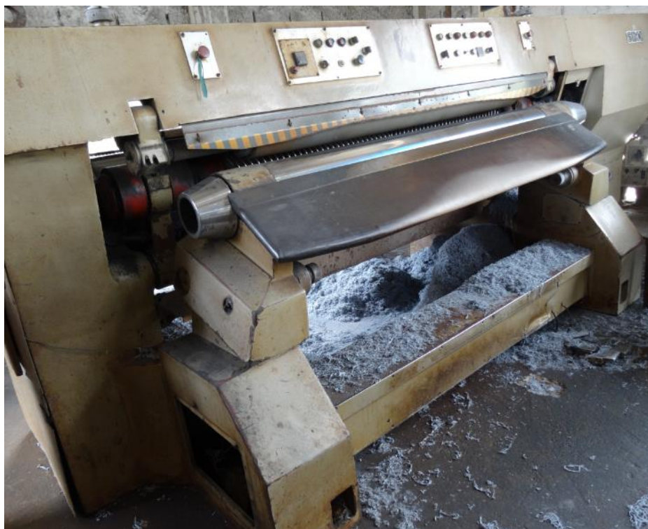
Figura 10 – Rebaixadeira e serragem resultante da operação de rebaixamento
