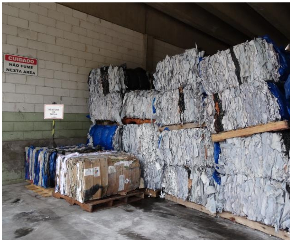
Figura 12 – Exemplo de bom armazenamento de resíduos (segregados, em área coberta, com piso impermeável e com placas de identificação)
