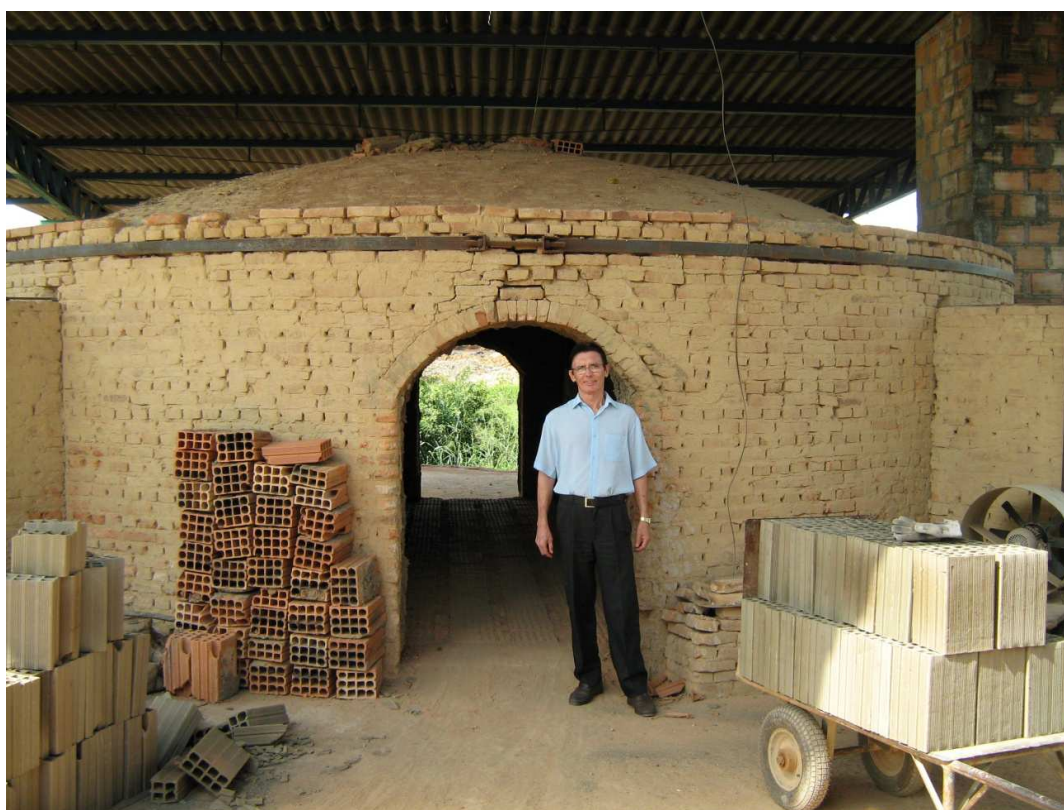
Figura 3-5 - Forno Abóboda mostrando as dimensões das entradas em relação a um referencial humano mediano.
