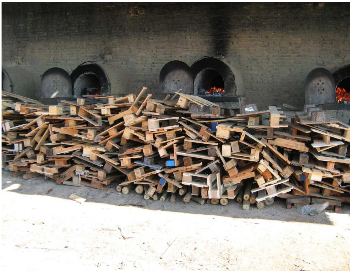
Figura 3-10 - Uso de pallet como combustível em fornos cerâmicos
