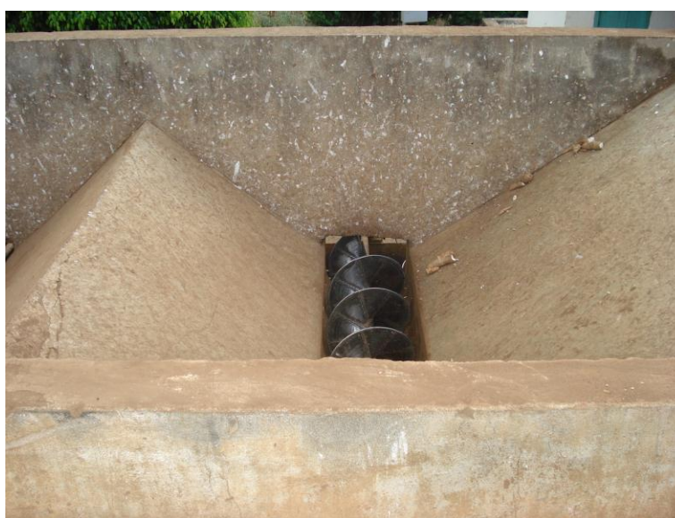
Figura 3. 6 - Recepção da matéria-prima (rosca sem fim).
