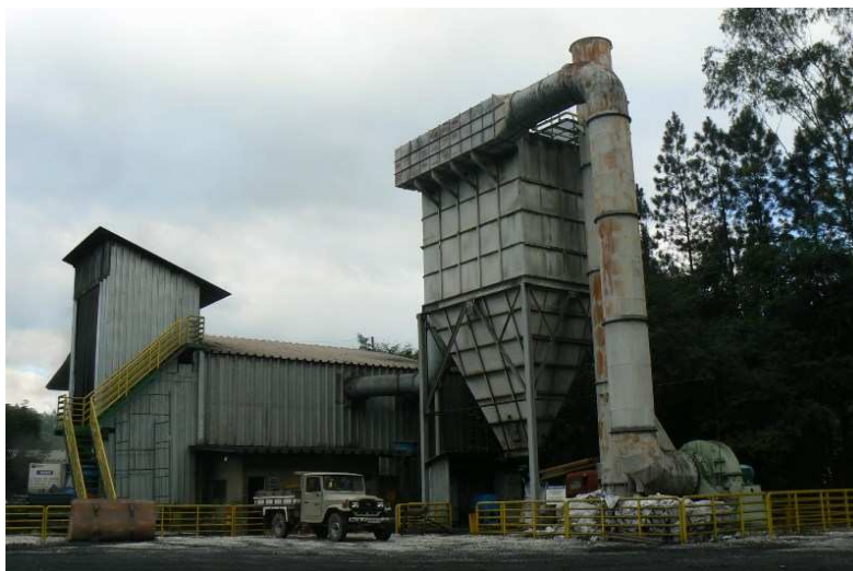
Figura 3.2 - Galpão de descarga de carvão vegetal e seu respectivo filtro de mangas
