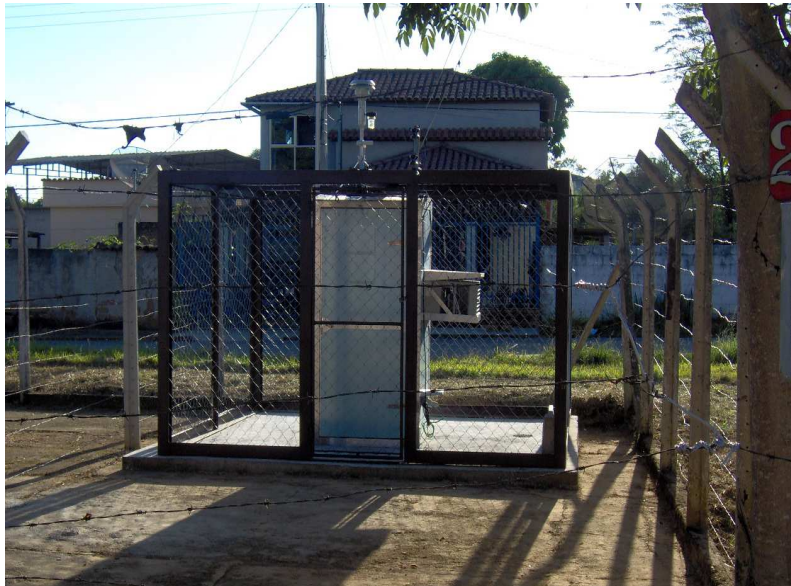
Figura 3.8 - Estação de monitoramento da qualidade do ar para o parâmetro PM_{10}
