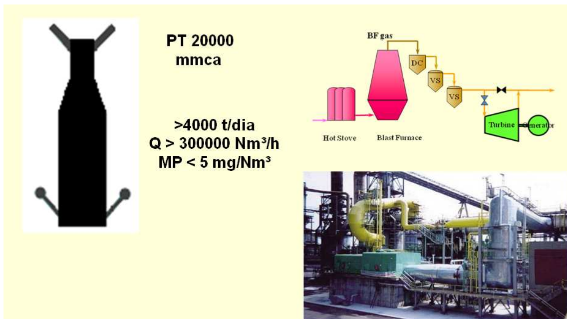
Figura 2.3 – Aproveitamento de gás de alto-forno a coque em turbina de recuperação de topo.
