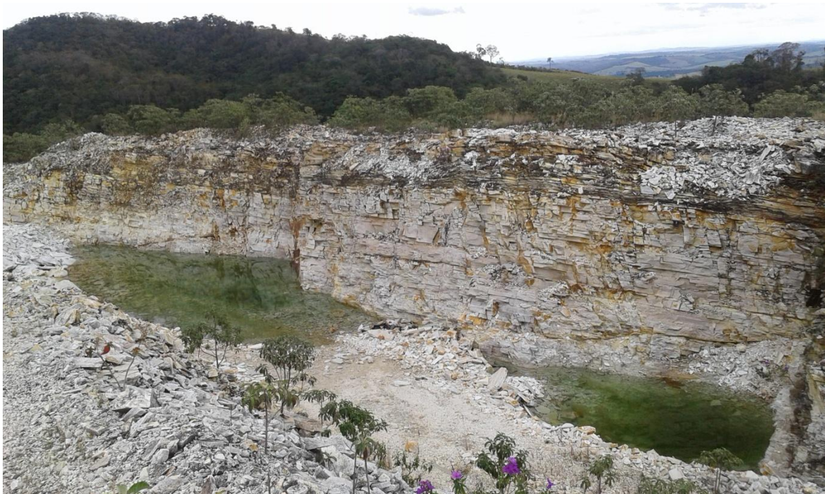
Figura 5 - Mineração de quartzito em São Thomé das Letras paralisada sem controle ambiental (O empreendedor apresentou PRAD ao órgão ambiental, mas observou-se em campo, que as medidas não estão sendo executadas).
