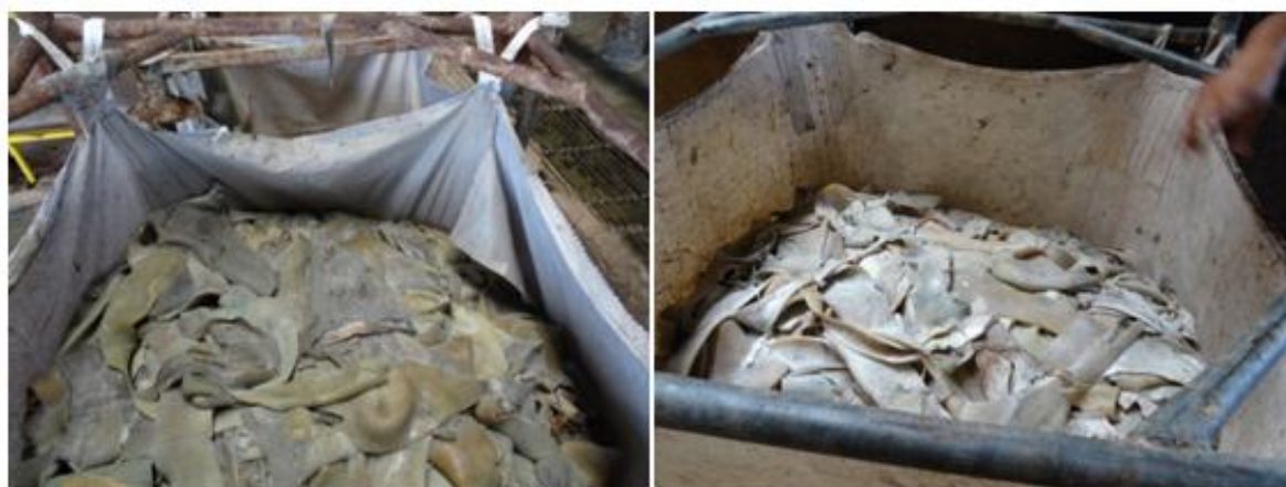
Figura 11: Aparas não caleadas (à esquerda) e caleadas (à direita)
