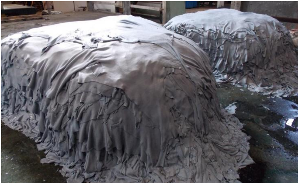
Figura 7: Couro wet blue logo após curtimento com cromo
