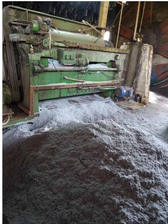
Figura 8: Máquina de rebaixar e serragem resultante da operação
