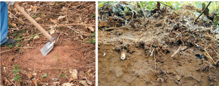
Figura 4. Limpeza do local de amostragem com remoção da vegetação e da serapilheira.
