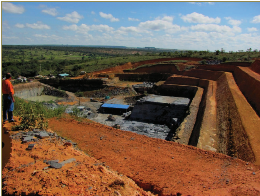
Foto 2.28 – Lavra de ardósia conduzida de acordo com as normas reguladoras da mineração, o que facilitará os futuros trabalhos de reabilitação da área minerada.
