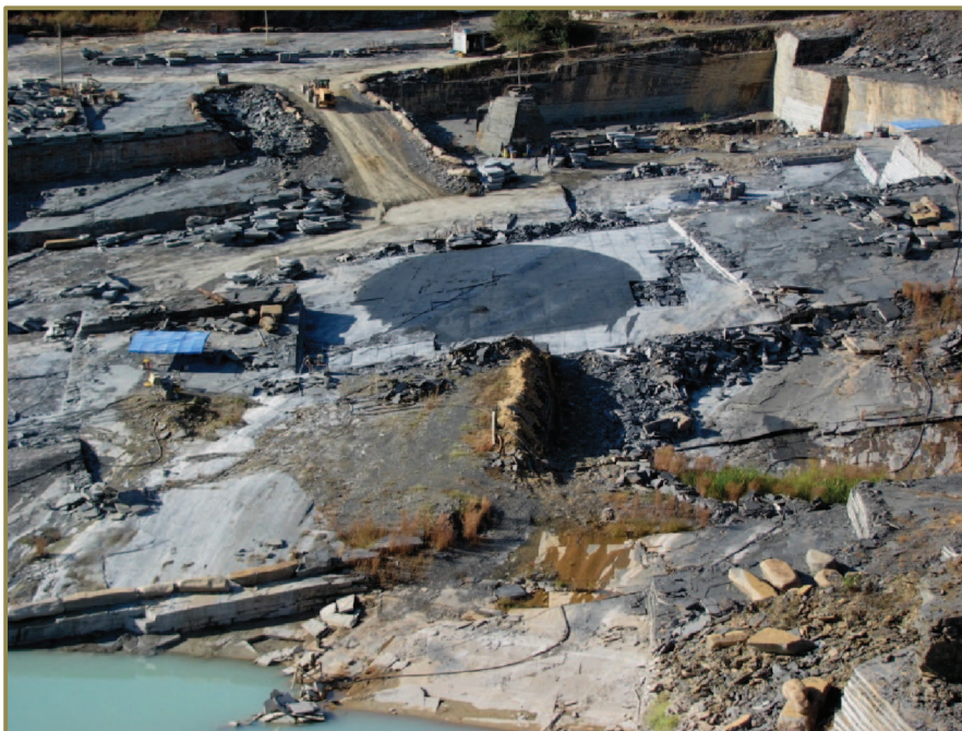
Foto 2.26 – Várias frentes de lavra, em atividade ou não, expõem a situação atual desta grande cava. Provavelmente não houve uma pesquisa mineral que embasasse a condução de um plano de lavra adequado. Consequentemente, a reabilitação dessa área será mais onerosa e difícil.
