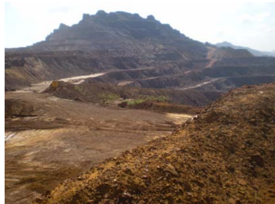
Figura 27 Registro em 2006 da frente de lavra desordenada com picos de itabirite e comparativo com o registro de 2011 da frente de lavra em bancadas
