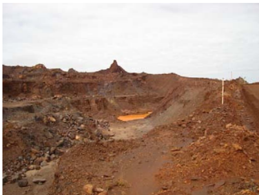
Figura 25: Frentes de lavra da MBL com sump para contenção de sedimentos.
