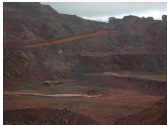
Figura 25: Frentes de lavra da MBL com sump para contenção de sedimentos.
