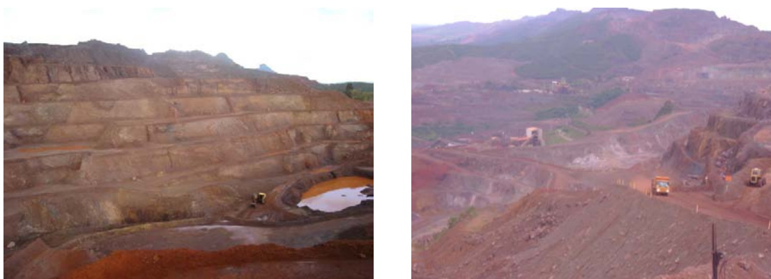
Figura 20 Frente de Lavra da Mina Itatiaiuçu, sendo desenvolvida em bancadas Fonte: FEAM, 2006 / YKS, 2011
