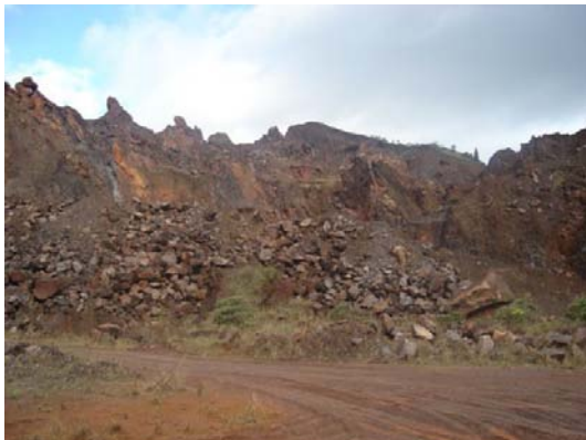
Figura 27 Registro em 2006 da frente de lavra desordenada com picos de itabirite e comparativo com o registro de 2011 da frente de lavra em bancadas
