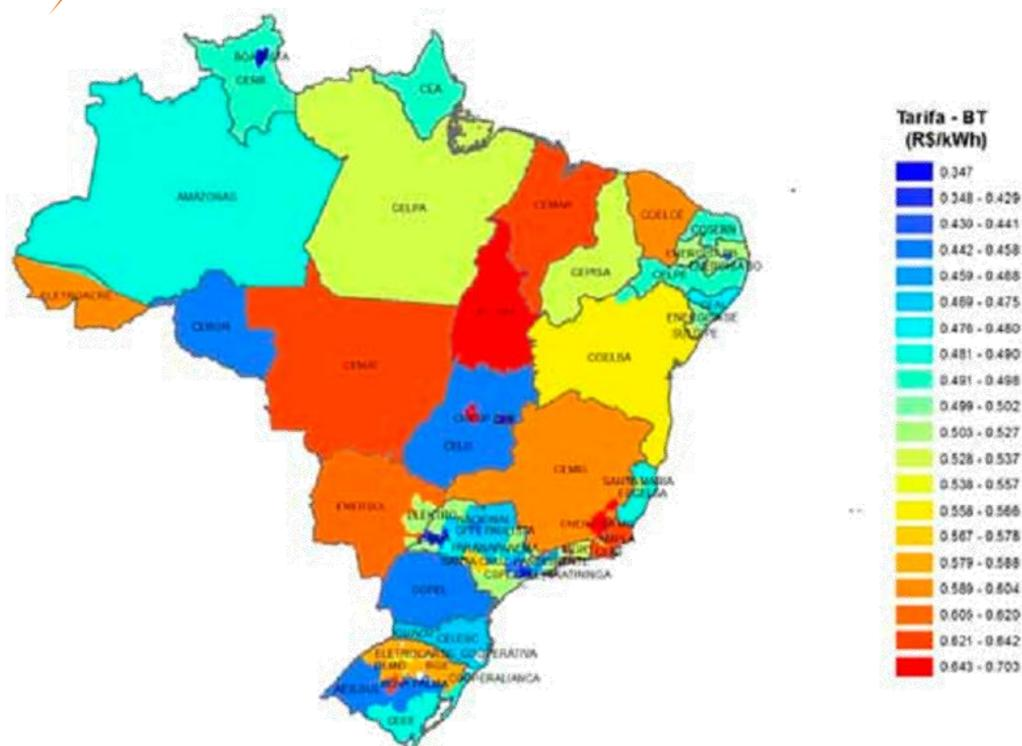
Figura 23 - Tarifa de energia com impostos para clientes na baixa tensão (Fonte: ABINEE, op.cit.)
