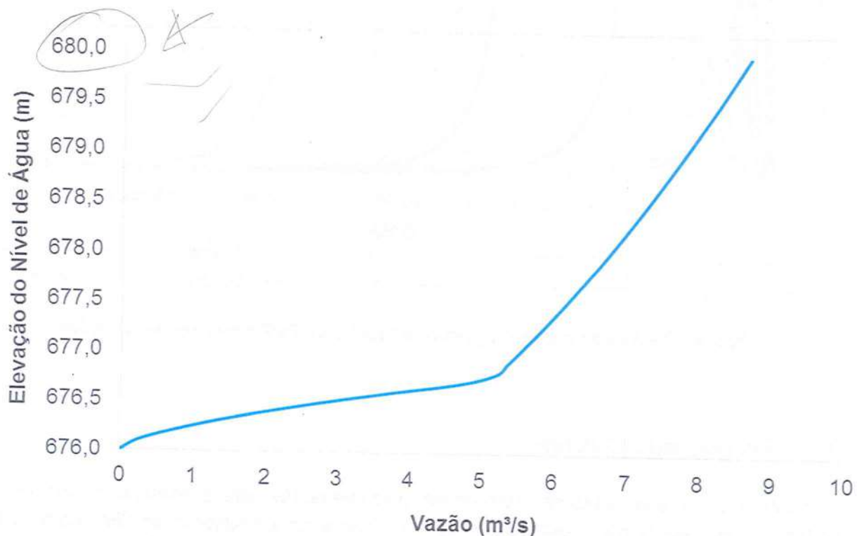
Figura 5.1 – Curva de descarga do sistema extravasor.
