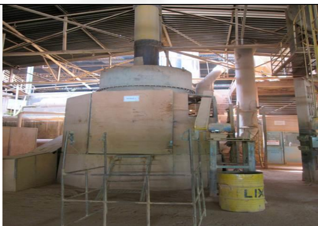
Foto 14: Moinho de bauxita revestido externa e internamente para diminuir ruídos
