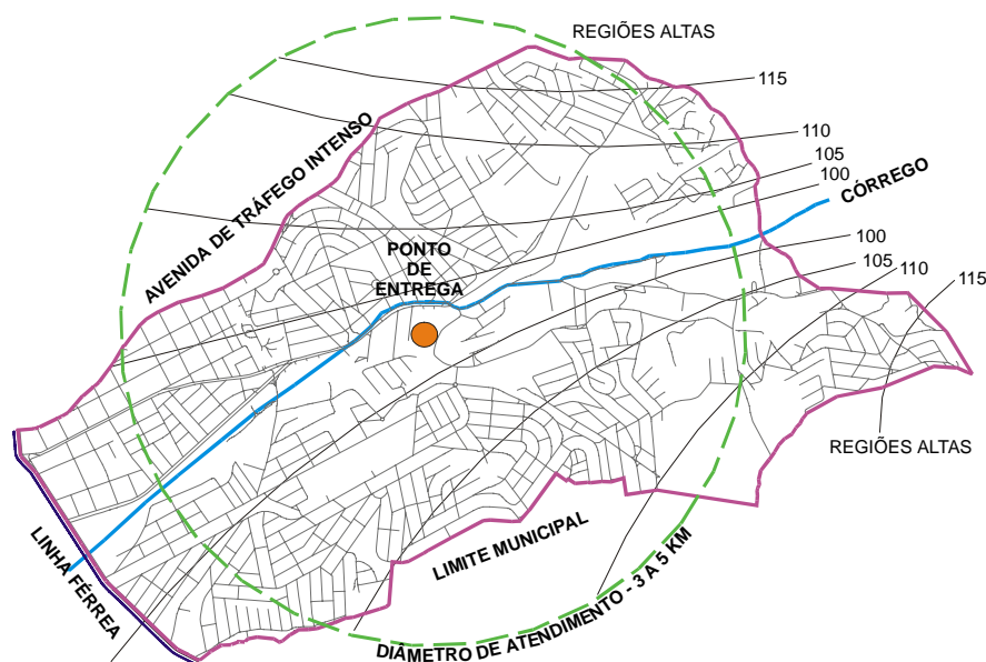
Figura 4 – Exemplo da definição de bacia de captação
