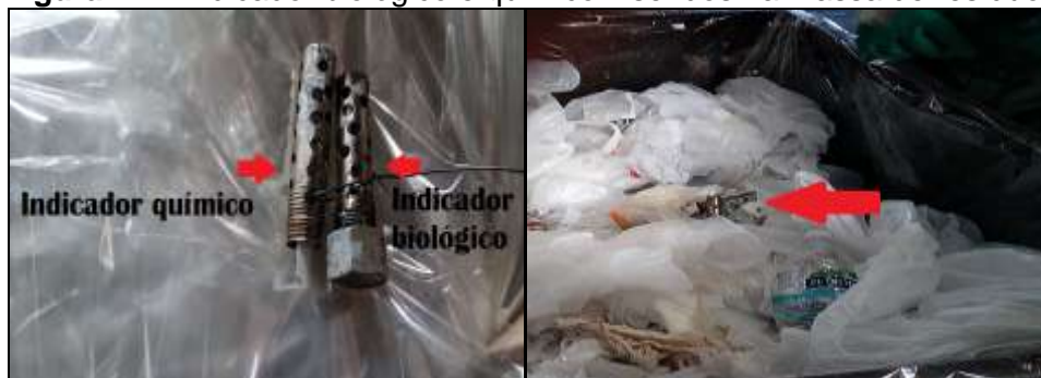
Figura 24 – Indicador biológico e químico inseridos na massa de resíduos
