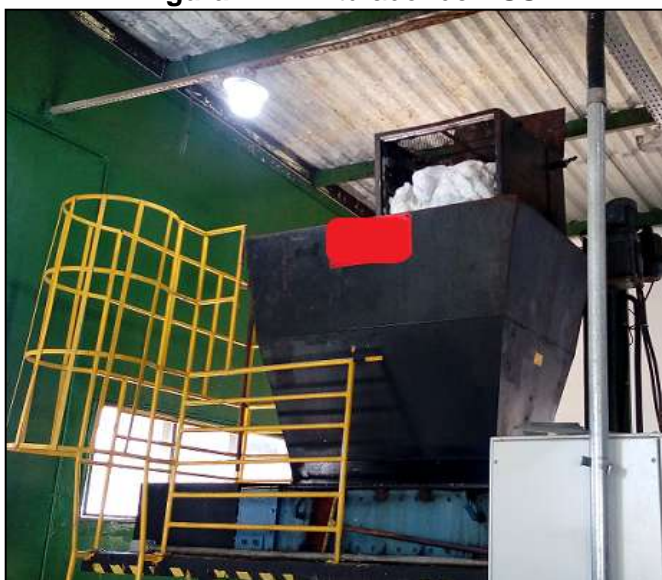
Figura 27 – Triturador de RSS
