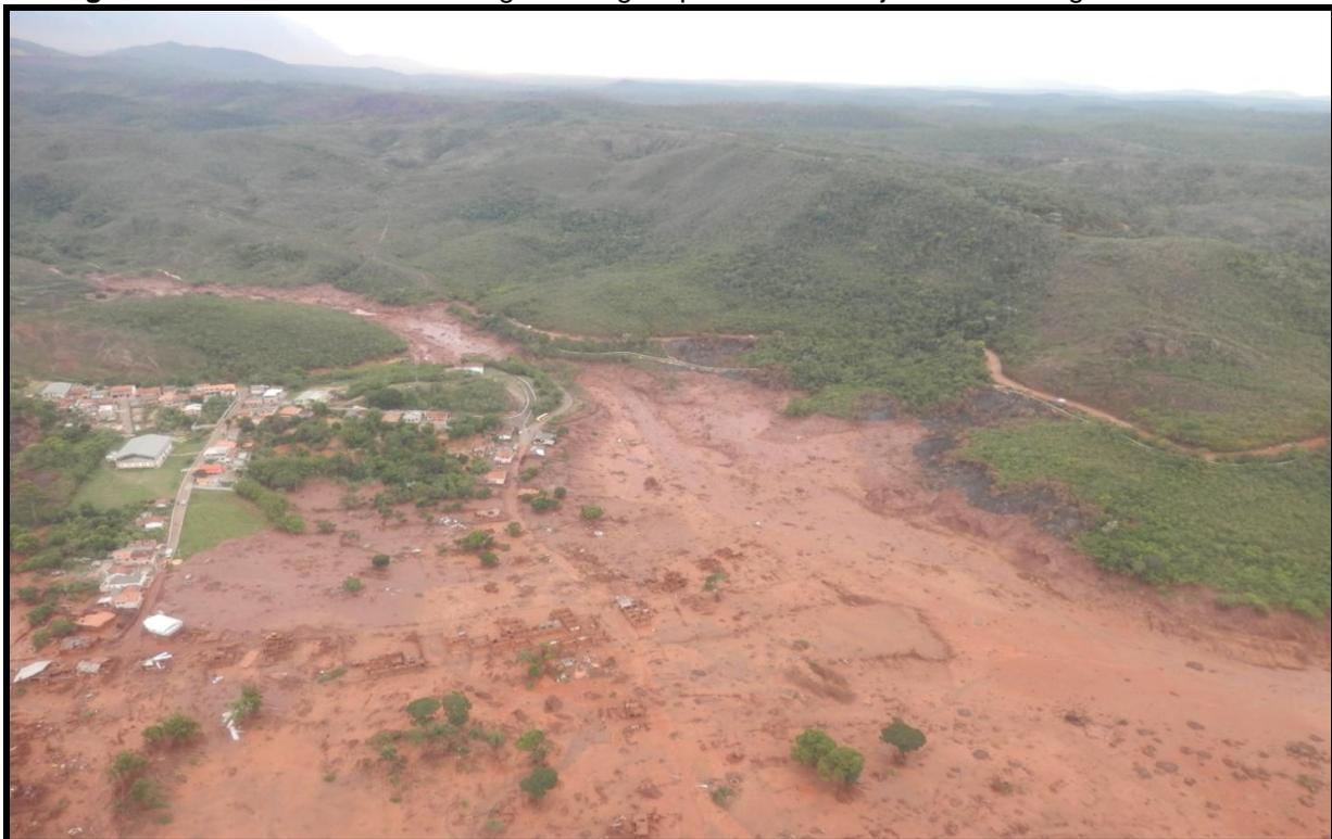
O rompimento da Barragem do Fundão causou efeito em cadeia, provocando o galgamento da Barragem Santarém que acumulava água. Dessa forma, quando o material contido na barragem rompida chegou a essa barragem, a água ali contida diluiu ainda mais o rejeito o que provocou aumento da velocidade da lama, causando grande dano ao meio ambiente.
