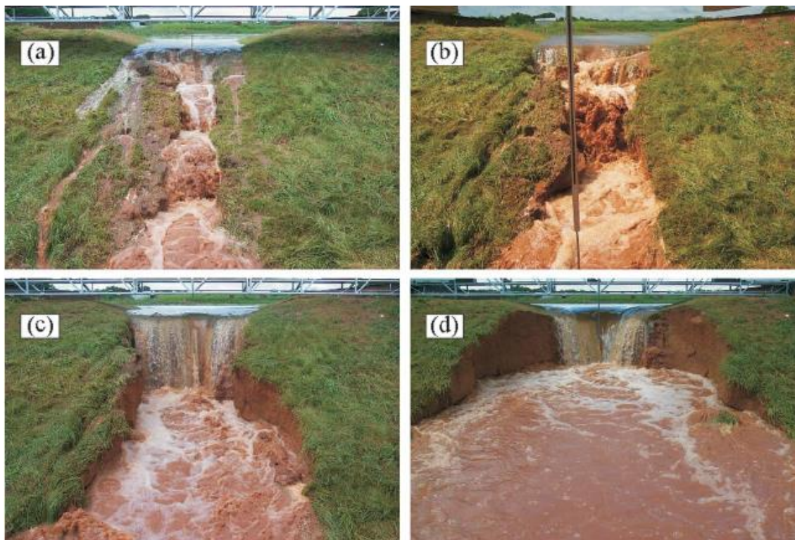
Figura 19: Evolução de um processo de galgamento. Fonte: Adaptado de Hanson et al. , 2005, apud Altinakar et al. , 2011.
