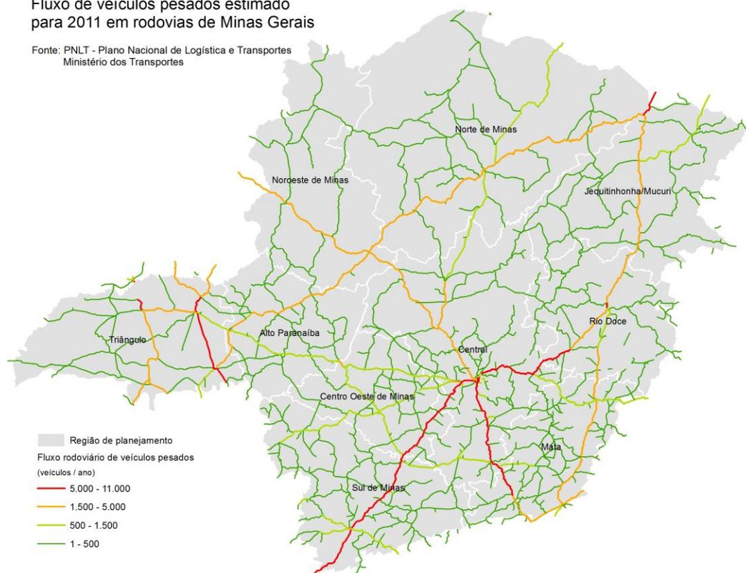
Figura 27 - Fluxos de veículos pesados estimados para 2011 em rodovias de Minas Gerais (PNLT, Ministério de Transporte)
