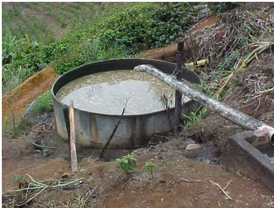
Figura 3-9 – Reservatório metálico de vinhaça
