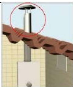
Chaminé com duto vertical e com chapéu chinês
