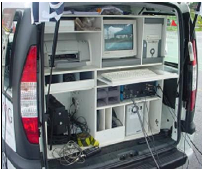
FIGURA 4.2 - Equipamentos de medição de emissões veiculares da Unidade Móvel
