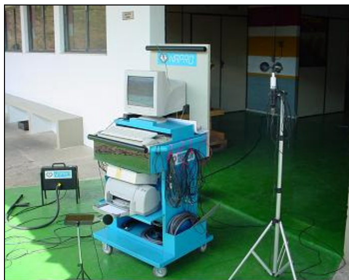
FIGURA 4.1 - Equipamentos de medição de emissões veiculares da Unidade Fixa
