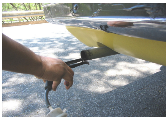
FIGURA 4.3 - Colocação da sonda de captação dos gases no escapamento
