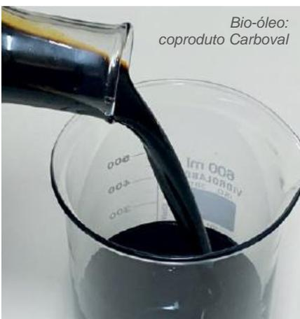
Resultante do processo da carbonização, a produção da Carboval também gera o **bio-óleo**, utilizado principalmente nas indústrias de combustíveis, química e alimentícia; e o **extrato pirolenhoso**, usado na indústria agrícola como herbicida orgânico e para condicionamento do solo.
